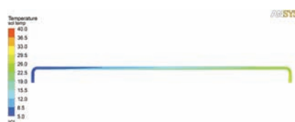
Rysunek 15. Rozkład temperatur w węzownicy gazu opałowego
