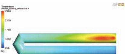
Rysunek 17. Rozkład temperatur w ścianie płomienicy, dół
