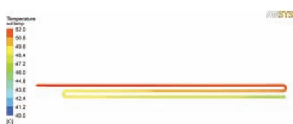
Rysunek 10. Rozkład temperatur w węzownicy wstępnej płynu złożowego. Wiązka 2 dół
