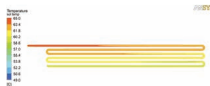
Rysunek 14. Rozkład temperatur w węzownicy solanki. Wiązka 3 dół
