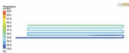
Rysunek 12. Rozkład temperatur w węzownicy solanki. Wiązka 1 góra
