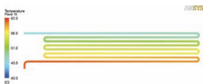
Rysunek 11. Rozkład temperatur w węzownicy dogrzewającej płynu złożowego
