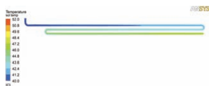
Rysunek 9. Rozkład temperatur w węzownicy wstępnej płynu złożowego. Wiązka 1 góra
