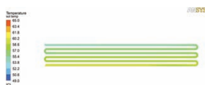
Rysunek 13. Rozkład temperatur w węzownicy solanki. Wiązka 2 środek
