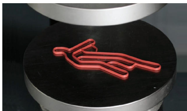
Rys. 1. Badane uszczelnienie między płytami maszyny wytrzymałościowej (fot. Tomasz Pietrzak)
