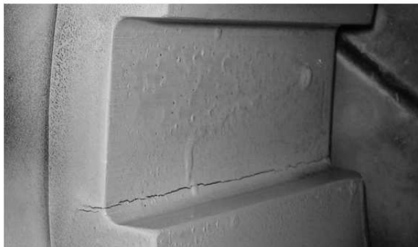
Rys. 1. Zdjęcie uszkodzonej tarczy po demontażu Fig. 1. Picture of disassembled shield
