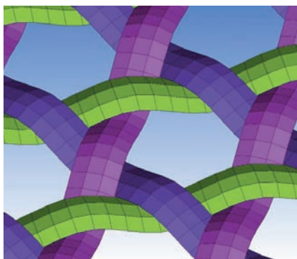
Rys. 6. Model dyskretny tkaniny trójosiowej
