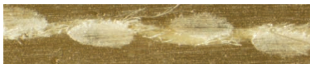
Rys. 2. Przekrój poprzeczny tkaniny trójosiowej
