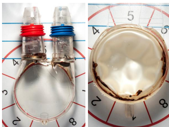
Rys. 5 Podział na sektory czaszy krwistej i membrany dla przykładowej pompy Religa Heart EXT
