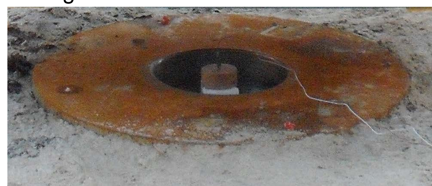
Widok ładunku TNT przygotowanego do testu wybuchu w stalowej płycie
